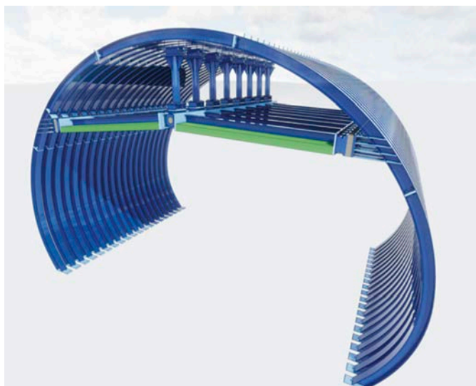
Bild 5 Zwischendecke visualisiert [3] Intermediate slab visualised [3]
